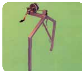
Telaio sollevamento con verricello manuale portata 350 kg.
